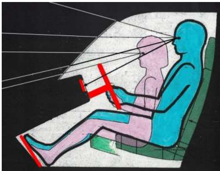
Harmonizace dosahu a výhledu malé řidičky a velkého řidiče při projektování kabiny automobilu
