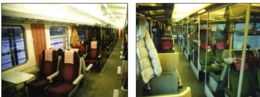
Kombinace velkoprostorového řešení a malých oddílů s užitím skleněných stěn, které izolují pouze zvukově. V celém prostoru vagónu však stačí jen 2-3 kupé pro ojedinělé hlučné skupinky.
