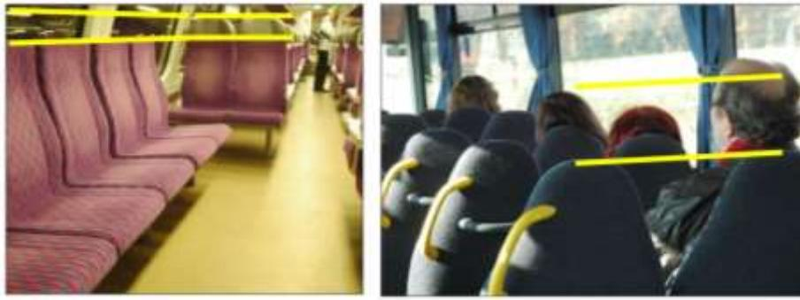
*K dosažení komfortu II. třídy je nezbytná výše opěráku umožňující plnohodnotné opření hlavy i pro cestující vyšší postavy. Na fotografiích sedadla III. třídy předměstské soupravy a autobusu.*
