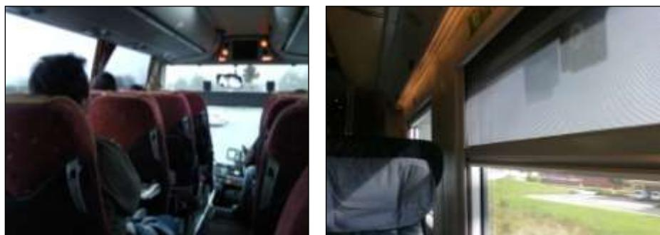
Zajímavým prvkem této problematiky jsou **roletky proti oslnění řidičů** autobusů. Jestliže cestující v předních řadách roletkou zamezíte ve výhledu dopředu (řidič často sedí níže než cestující), vytváříte v nich trvalé napětí. V promyšleně řešených autobusech se proto již užívají malá stínítka fungující jen v rámci zorného pole řidiče a nad ním ponechávající nekrytý prostor neomezující výhled pasažérů.
