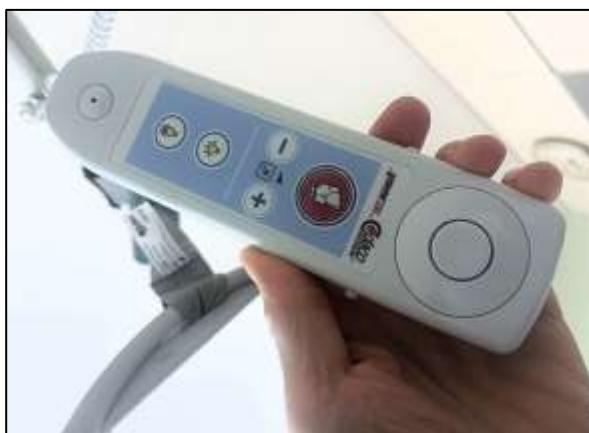
*Telefon na sesternu a plynulý regulátor lokálního osvětlení. Styl a čitelnost grafických prvků signalizují nízkou profesionalitu výrobce. Ovladač musí být přiměřeně umístěn v dosahu a zajištěn proti pádu na zem.*
