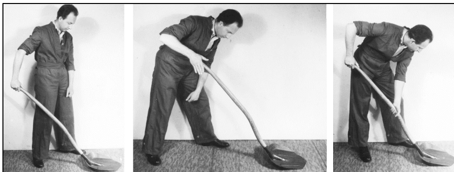
Testování nově vyvinuté násady lopaty v laboratoři
