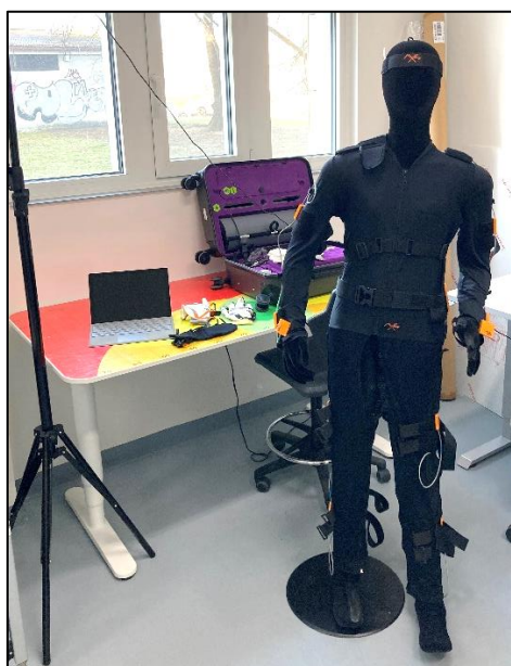
Testovací oblek Motion Capture s detektory pohybu a síly od firmy AXS. V pozadí pracovní plocha stolu s barevně vymezenými zónami dosahu.
