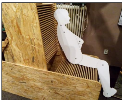
Schématický model lidské postavy na testovací lavici. Pro potřeby kvalitativního srovnávání byla shromážděna série železničních sedadel v expozici na nádraží.
