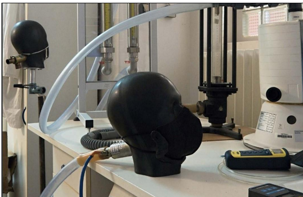
Zařízení na testování funkčnosti respirátorů Laboratoře VÚBP Praha Ilustrace archiv Výzkumného ústavu bezpečnosti práce Praha
