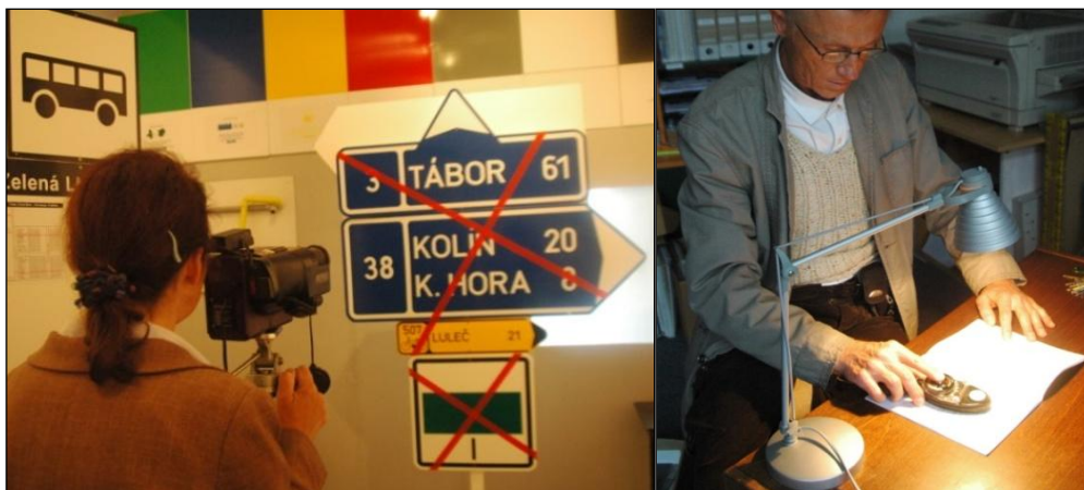
Testování čitelnosti vizuální komunikace jednoduchou srovnávací metodou rozostření, vpravo měření osvětlení pracovní plochy, které má odpovídat státní normě.
