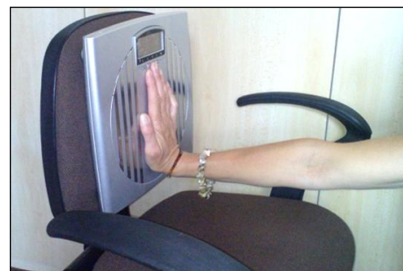
Silová měření související s funkčností nábytku: síla potřebná k posunu dveří, silový odpor opěráku.
