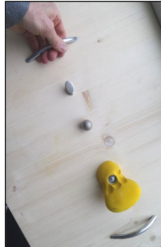
Vlevo měření síly tahu při pohybu tašky se speciálním „podvozkem“, vpravo deska s testovacími prvky různých úchytů pro ruku.
