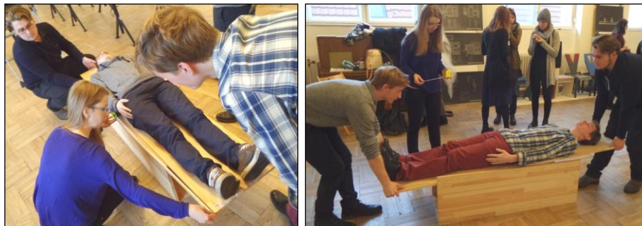
Jednoduché laboratorní vahadlo slouží k určování polohy těžiště těla.
