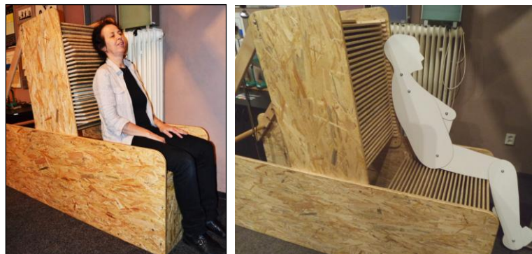
Speciální lavice slouží k modelování optimálního tvaru sedáku a opěráku. Dnes je to možné dělat i pomocí elektronického systému, ale ten je málo dostupný. Figurína vpravo se ovšem nepoužívá k demonstraci tlaku na podložku, ale k prezentaci rozměrových souvislostí.
