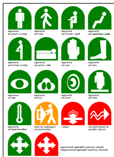
Ukázka základního souboru symbolů pro značení ergonomických kvalit produktů. Podle mezinárodního barevného kódu je pak pozitivní kvalita značena zeleně, negativní červeně, žlutá barva je vyhrazena rizikům.
