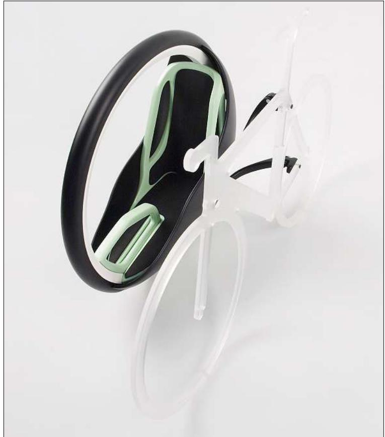
»Kompagnon«; Fahrradbeiwagen; Designmodell aus Kunststoff (PVC), Rapid Prototyping, CNC-gefräst; 23×50×30 cm
