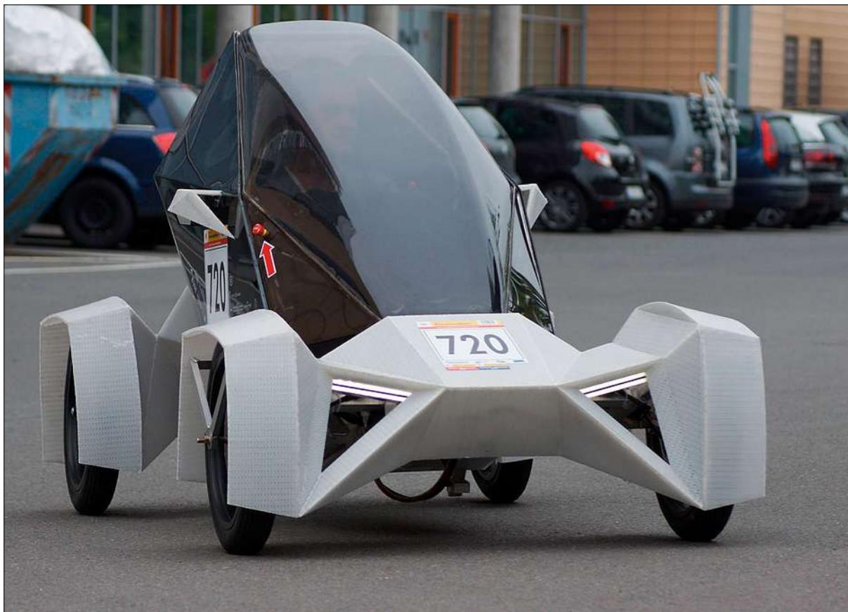
»TILT«; Experimentalfahrzeug; Polypropylen, Lignin, Stahl, Aluminium, PET-G; 130×130×250 cm
