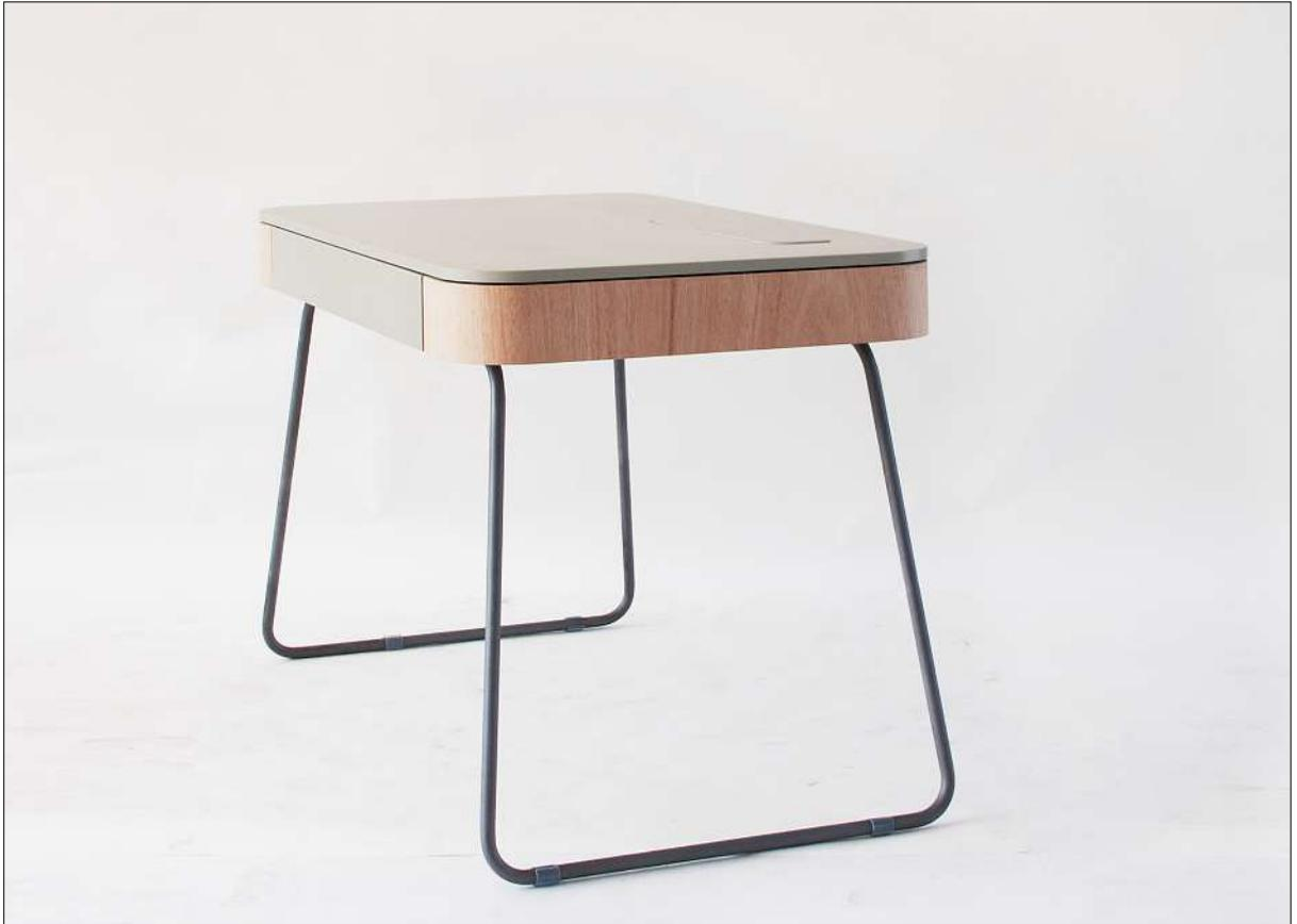
»Rotunde«; Schreibtisch; MDF/Biegesperrholz, Stahlrohrgestell, Formverleimung (Biegesperrholz), CNC-gefräste Teile, gedübelt, lackiert, gebogenes und geschweißtes Stahlrohr; 79×126×70 cm
